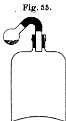
Fig. 55. Verbrennen von Arsen-, Antimon-, Wismutpulver in Chlorgas.
