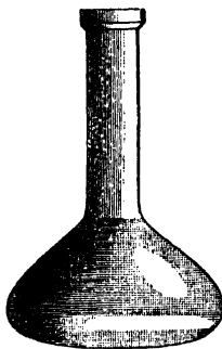
Tonfilter nach Pukall zum Filtrieren von außen nach innen.
