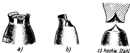
Typische Bruchformen beim Zugversuch von Stahlstäben. (Schematische Darstellung.)
