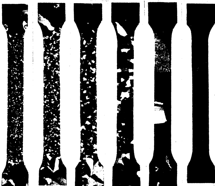
Rekristallisierte Aluminiumstäbe nach Dehnungen von 10, 8, 6, 4, 2 und 0 Proz. (lin. Vergr. 0,85).
