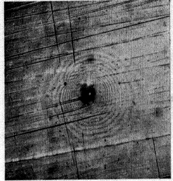
FIG. 43.—Normal Pore ( \times 80 ).
