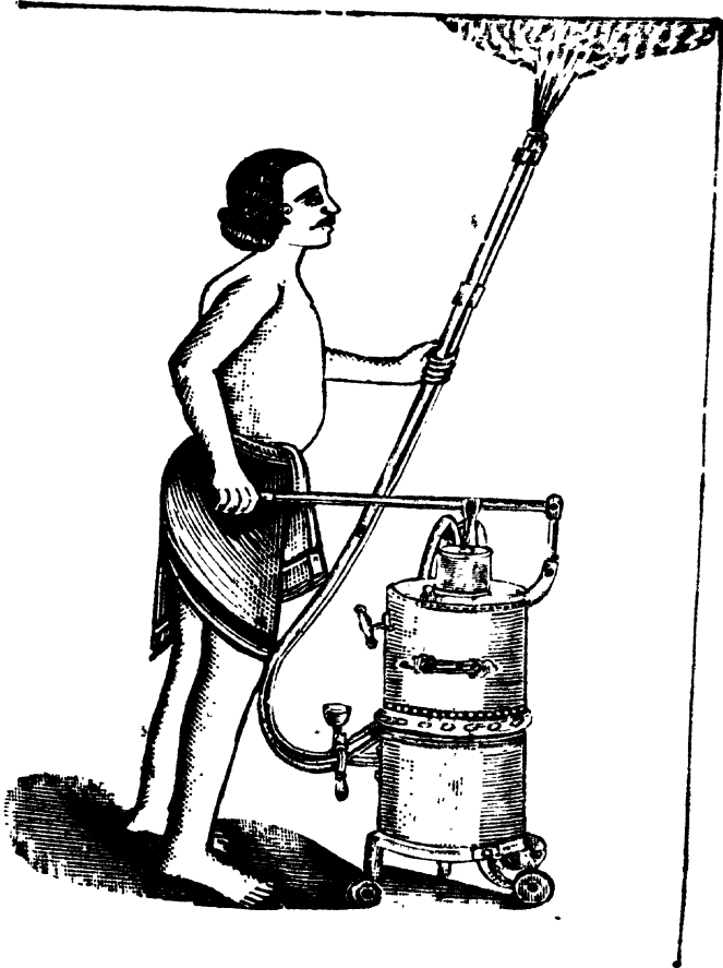
గోడలమీద నుండులనీళ్లను చల్లుటకు పయోగించు చిమ్మెడు గొట్టము(Pump)
